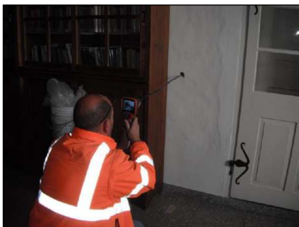
Fase della videoispezione e registrazione
