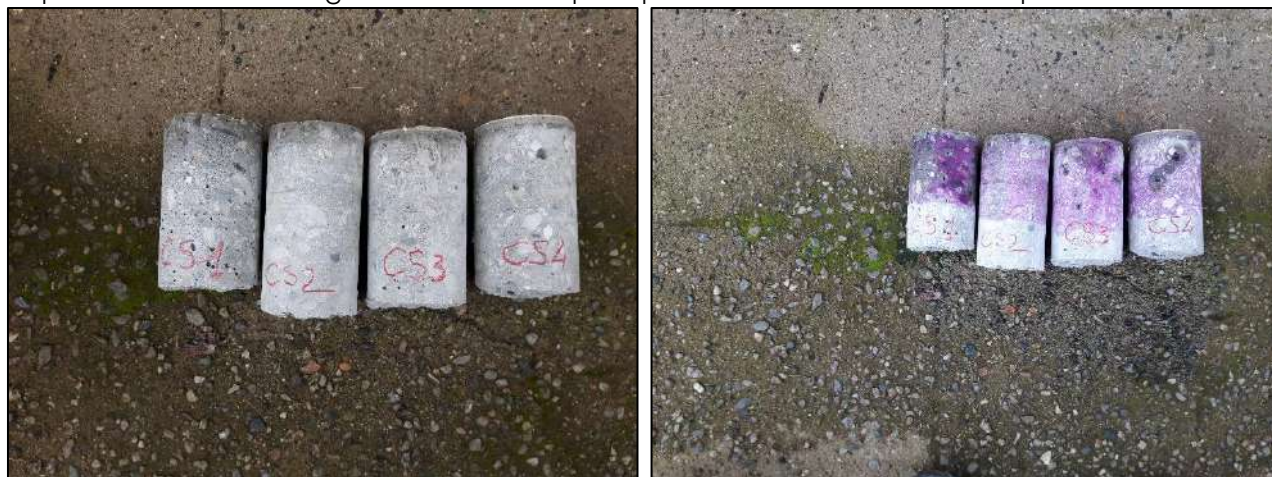
Campioni prelevati e prova colorimetrica.
