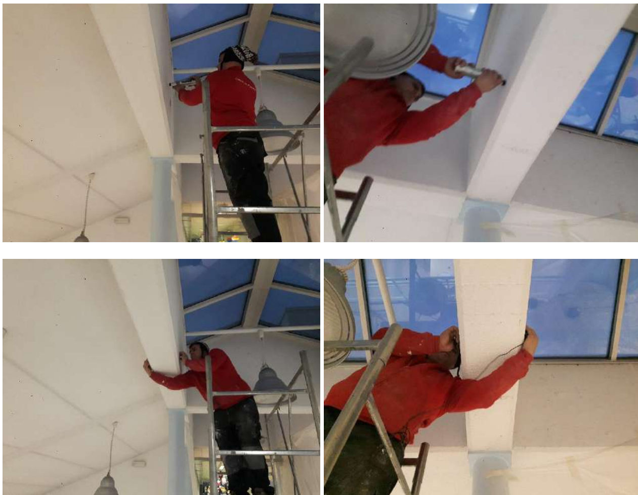
Alcune fasi delle prove sclerometriche e ultrasoniche.
