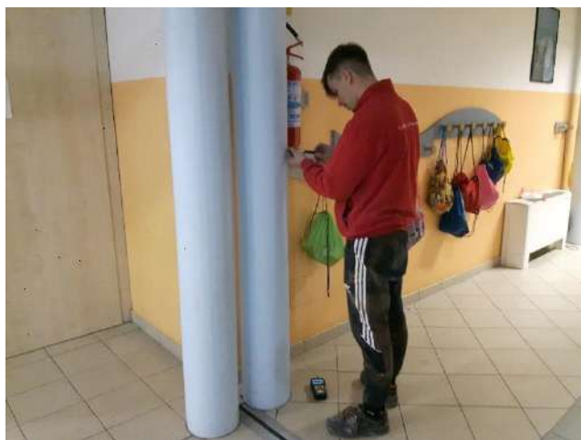
Alcune fasi della verifica con microdurometro.
